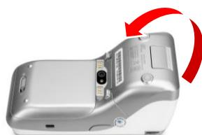
①端末本体裏プリンタカバーの開閉レバーを指で引き上げ、カバーを開きます。
